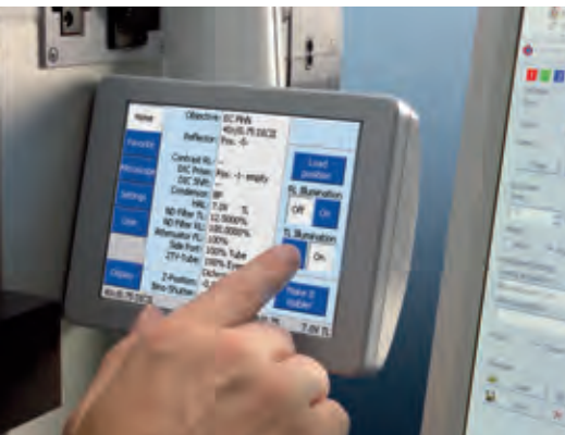
在TFT屏上设定照明
