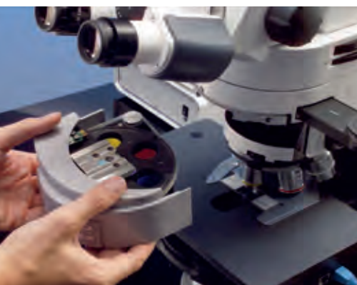
简单并快速：由手动转为自动化反射转盘
